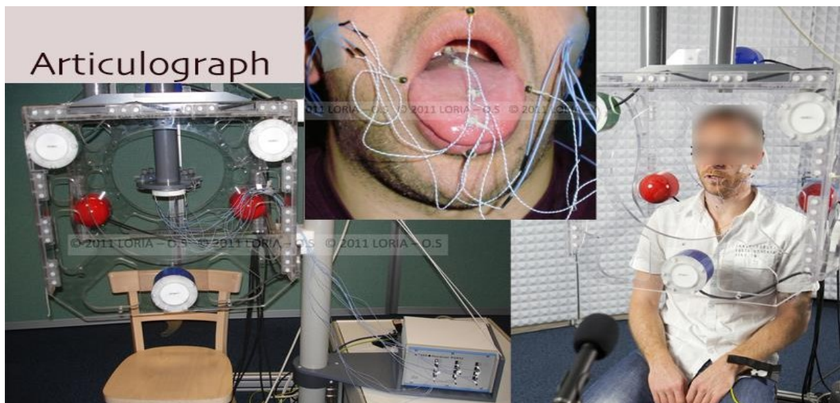
Figure 1 : Articulographe électromagnétique. Cette technique permet de suivre les mouvements de petits capteurs sur 3 axes de façon synchronisée à un enregistrement sonore ; ces capteurs sont collés sur les articulateurs et leur positions sont reconstruites à l'aide d'un champ électromagnétique.
